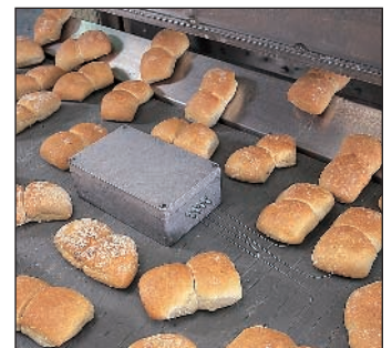
仪器置于绝热盒内, 检测烘烤生产线温度
