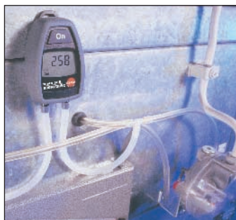
测量烟气流速或检查通风管道
