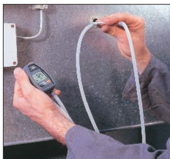
用皮托管测量风速
