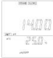
3. pH 模式 显示酸碱度和温度
